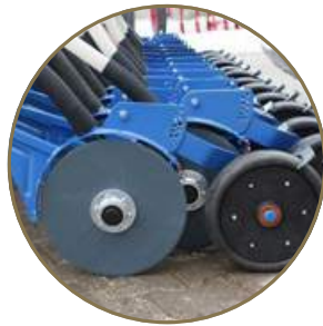
Disc, axe and hoe coulters types
